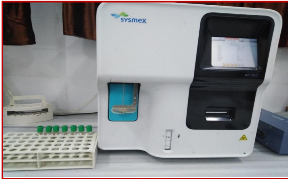
شكل (3-3) جهاز تحليل الدم CBC المستعمل لتحليل العينات داخل مختبرات أبن النفيس بالزاوية
