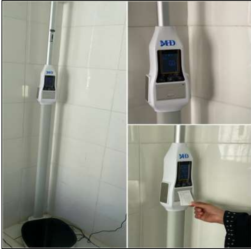
شكل (2.3): جهاز MD الأوتوماتيكي المستخدم في قياس الوزن والطول ومؤشر كتلة الجسم، والمزود بطابعة حرارية لإخراج النتائج مباشرة
