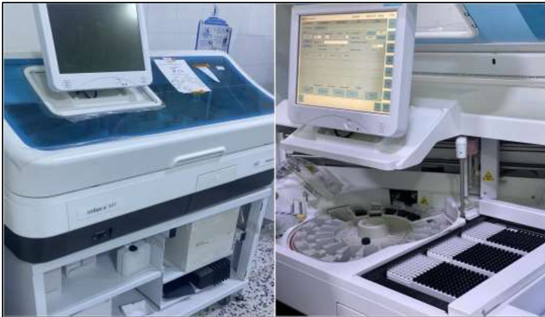
شكل (3.3): جهاز Cobas e 411 analyzer المستخدم في تحليل فيتامين (د) باستخدام تقنية التحليل الكيميائي المناعي الكهربائي (ECLIA)، من إنتاج شركة Roche Diagnostics
