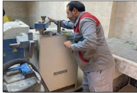
صورة (3) جهاز التفريغ لإشباع العينات بالماء
