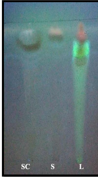
شكل (12) : يوضح الفصل الكروماتوغرافي بواسطة كروماتوجراف الطبقة الرقيقة وعدد النقاط الممثلة للمكونات المفصولة
