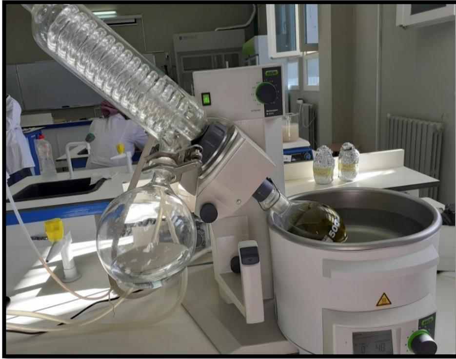
الشكل رقم (6) يبين جهاز المبخر الدوار Ratatory evaporator
