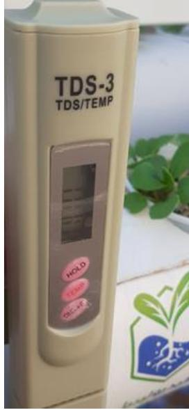
شكل 7: جهاز قياس الملوحة.
