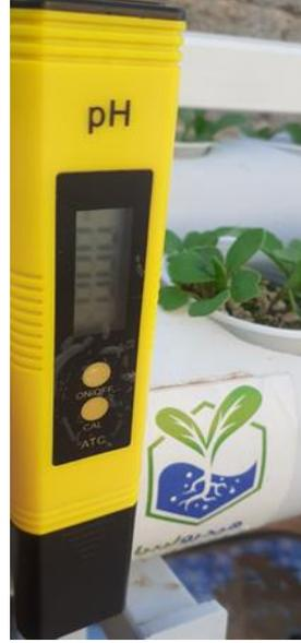
شكل 6: جهاز قياس الحموضة.
