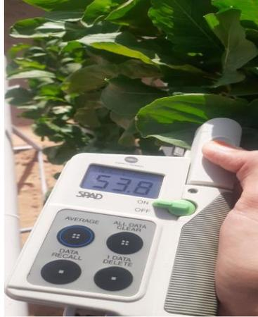
شكل 8: جهاز قياس محتوى الكلوروفيل في أوراق نبات الجرجير.
