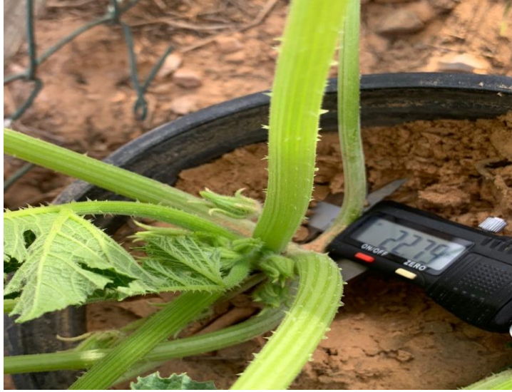
شكل 13: كيفية قياس قطر الساق باستخدام القدمة ذات الورنية الرقمية.
