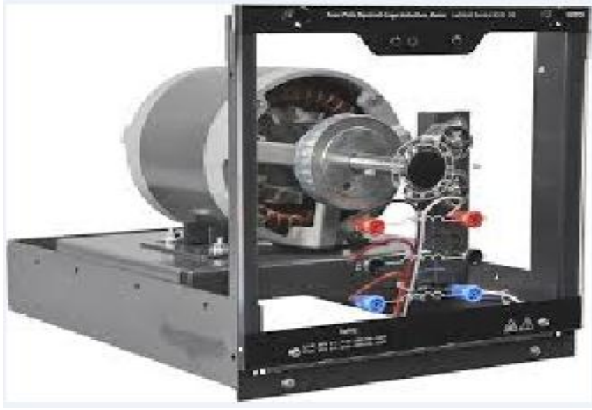
شكل (2): المحرك الحثي ثلاثي الطور المستخدم في التجربة العملية [5 و 7].
